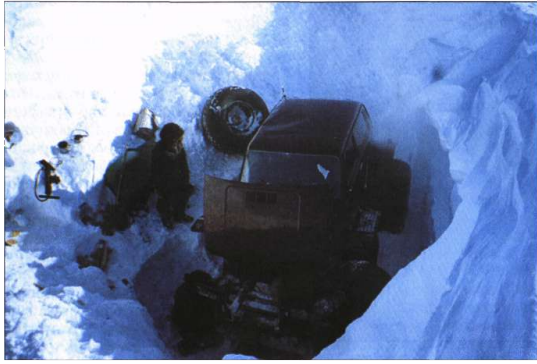
Ремонт во рву поломанного переднего моста.
